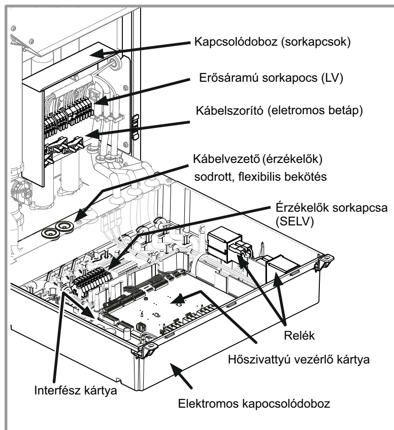
30. ábra - Elektromos kapcsolódoboz felépítése
